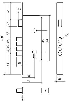
Cerradura ANTIPALANCA / Palanca de barras de acero / Picaporte reversible / 2 vueltas / Perfil: 25 x 3 mm. / Cilindros: DS-15 / Entradas: 50 mm / Distancias: 85 mm / Acabados del frente: Latón cromado / Cromo mate / Esmaltado Oro / Negro / Escudos: 410-P / Cerradero corto
