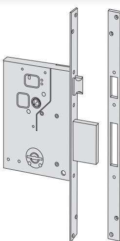
Grado 3 Seguridad de la norma europea EN 12209. Los dientes de arrastre de la palanca han sido diseñados para romperse en caso de intento de efracción. El dispositivo de bloqueo en la espiga está endurecido y redondeado térmicamente, para dificultar su perforación. El sistema de cifrado de las llaves con borjas independientes hace más difícil reproducir la combinación de la llave.
