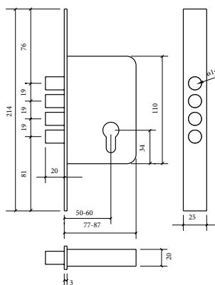
Cerradura ANTIPALANCA / Palanca de barras de acero / 2 vueltas / Perfil: 25 x 3 mm. / Cilindros: DS-15 / Entradas: 50 mm. / Escudos: 410-P / Cerradero corto
